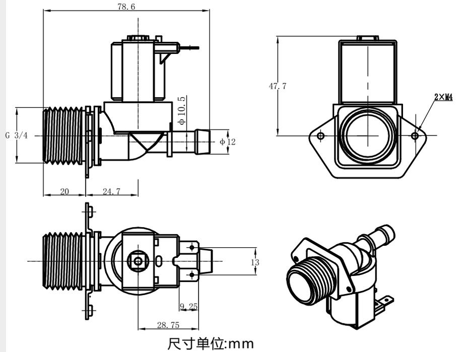
LFV18系列电磁阀，主要用于家电类洗衣机和洗碗机、净水器、咖啡机。通过线圈通电，产生磁性，带动阀芯，通过升压孔改变进水阀内部压力变化,完成进水开关动作。
